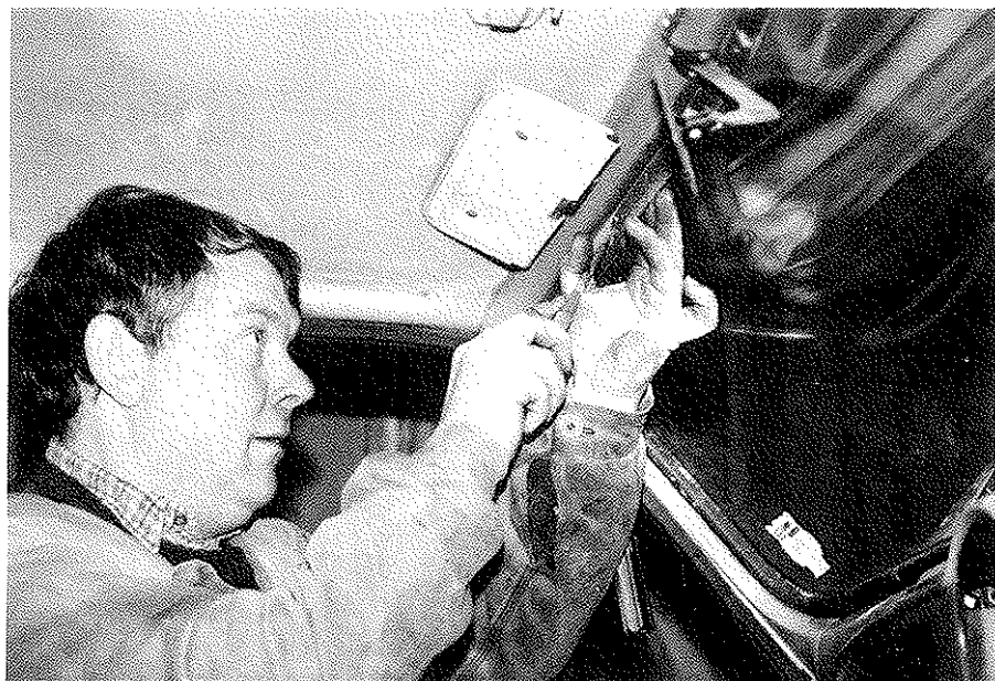
Start med at pres gummilistens kant om på den anden side af metalkanten.
