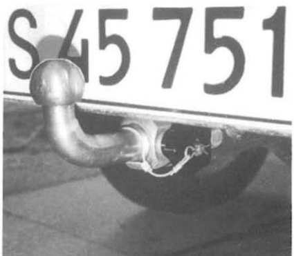
Trækket som det ser ud uden krog. Hullet til krogen og den gennemgående bolt er dækket af en stor gummiprop.
