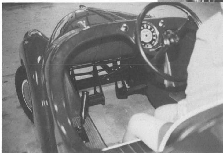
Instrumenteringen i Minor Junior. Pedaler, håndbremse, speedometer og kontakter til lys og horn.
