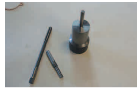
Specialværktøjet på dette billede består af centreringsdorn til bunden af karburatoren. Rival på 7,95 mm til de medfølgende stålboes til den nye gasspjældsaksel, samt værktøj til at montere de 2 boes med. Det er vigtigt at de nye boes kommer helt ind til indersiden ved gasspjældet.
