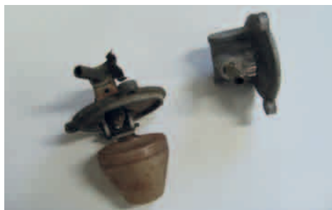
Svømmerhusets udluftning sidder skjult under den lille metalplade ved benzintilførslen. Har karburatoren stået ubrugt i flere år, er udluftningshullet ofte spærret til.
