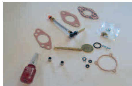
Her ser du reparationsset med dele til renoveringen. Ud over de viste dele kan en ny nål komme på tale.
