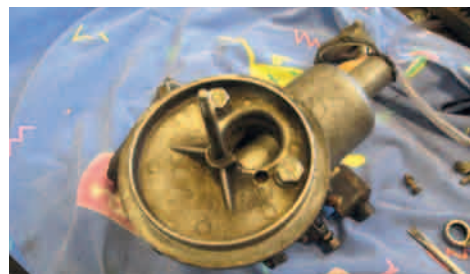
På dette billede er flangen til luftfiltret vendt forkert. Det lille hul ved skruen i højre side skal være i den anden side af karburatoren hvor der er hul ind på bagsiden af dæmperstemplet.
