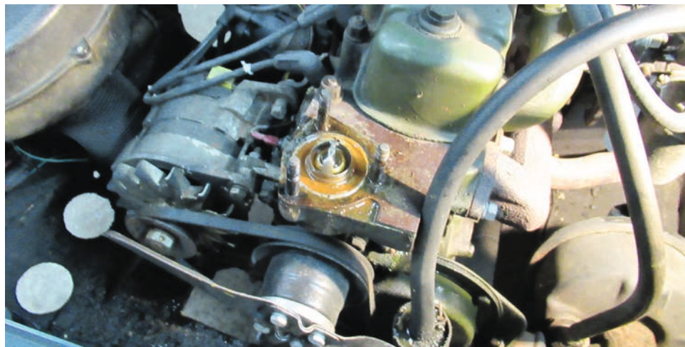
Termostaten sidder under et dæksel oven på vandpumpen.
