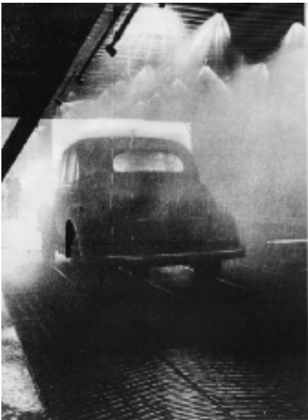
Vejprøverne: Kan den tåle uvejr? 1200 vanddråber fra alle vinkler, der svarer til et regnvejr på 300 mm i time. Finder den mindste fejl ved karosserisamlingen.
