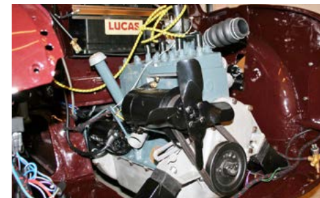
Ny renoveret sideventilet motor er på plads.
