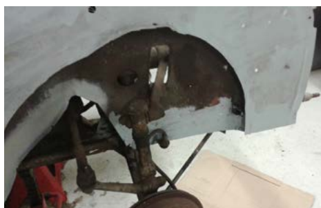
Inderskærme svejst og grundmalet.
