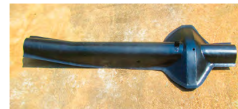
CHS281 Kardantunnel er een af de forholdsvis nye pladedele.
