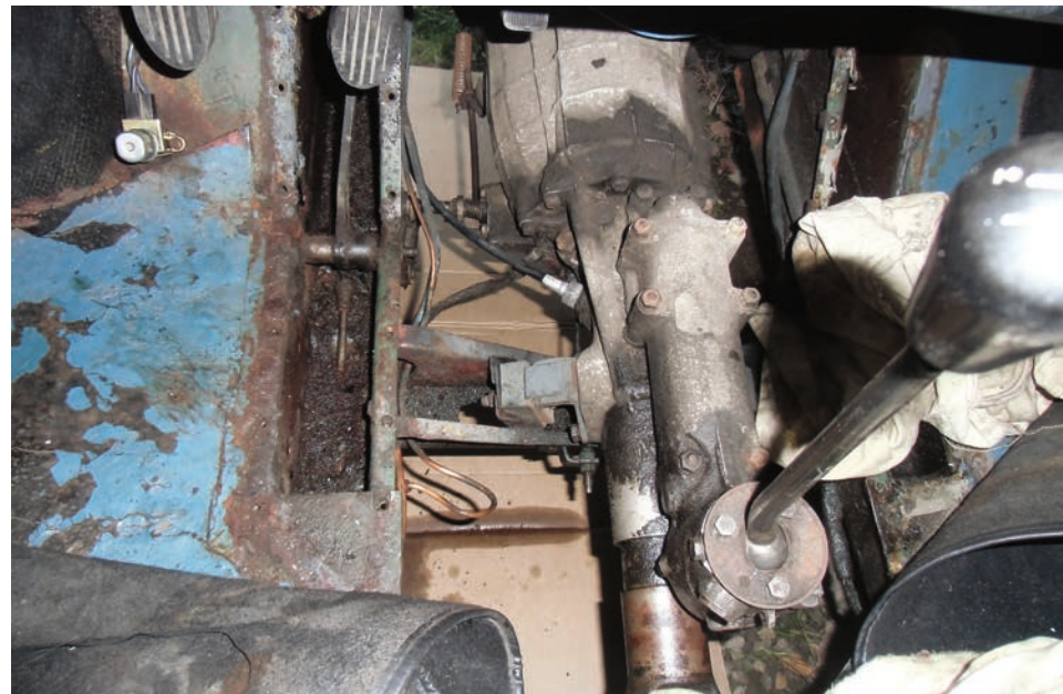
Bundplader afmonteret og hovedcylinder afmonteret fra vangen.
