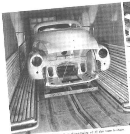
Nu kommer karosseriet kørende på en slirne-trulley ud af den store tørbakke.
