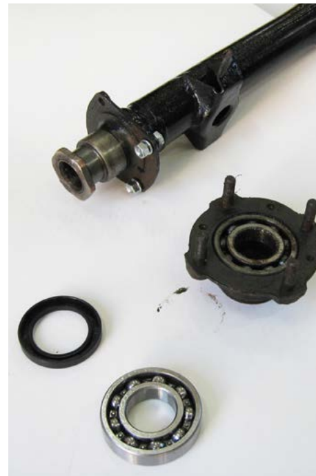
Ud over pakdåse og leje skal du også bruge papirpakningen og O-ringen der ligger mellem lejehuset og bagakslen.
