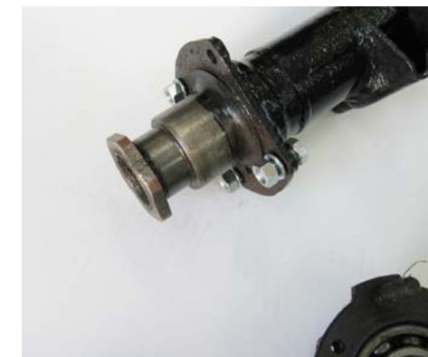
Bagaksel røret kan være meget slidt. Den store flange skal være intakt.
