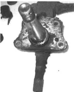
Gammel helt opslidt spindel.
